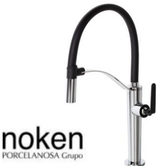
GRIFERÍA DE COCINA NOKEN LINEA MAGNET EXTRAÍBLE Monomando fregadero con ducha extraíble y caño giratorio. Incorpora cartucho cerámico de Ø25 mm con conexiones de 3/8", una longitud de latiguillos de 529 mm y aireador "Plus".
